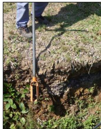
**Figura 31** – Drenagem central à área da mina do pilar, mostrando o perfil do terreno com presença de fragmentos de arenitos, siltitos, argilitos e secundariamente carvão.
