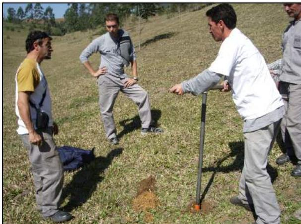
**Figura 23** – Trabalho de sondagem rasa visando investigar a camada de solo orgânico e os fragmentos de estéreis, como arenitos, argilitos carbonosos, carvão e siltitos na área da Mina do Campo.
