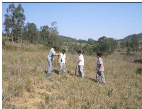
**Figura 32** – Realização de sondagem rasa na área da antiga mina da Figueira, que visou o conhecimento da cobertura de solo e o dos fragmentos superiores da pilha de estéril.
