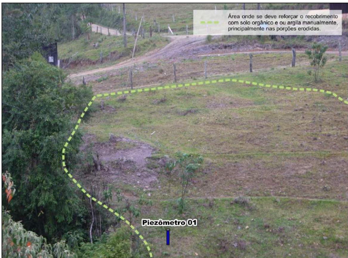
Figura 45 – Esquema de instalação dos piezômetros e recomendações na área da antiga mina do Pilar
