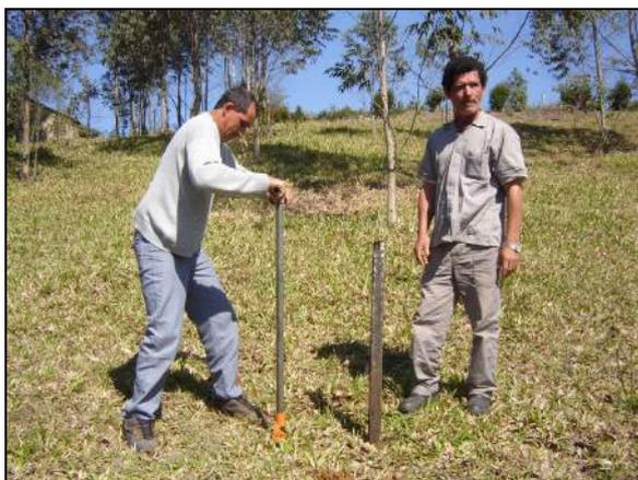
**Figura 40** – Equipe realizando sondagem com trado holandês para observação do perfil do solo.
